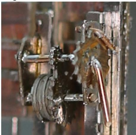
Durch das untere Loch in den Wangen wird ein Stück 0,3mm Bronzedraht gesteckt. Dabei auf den Draht zwischen den Wangen 5 Seilscheiben (8) aufstecken. Jeweils abwechselnd eine größere und eine kleiner. Ganz rechts folgt dann ein Doppelzahnrad (10). Wobei das große Zahnrad aufgefädelt wird.
