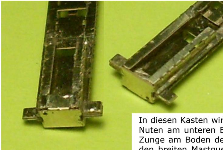
Am **Bock für den Mastfuß** (13) zuerst die 4 seitlichen Flügel an den perforierten Falzen zu L-Profilen (90° - Falz innen) biegen. Das geht am besten mit einer kleinen flachen Spitzzange. Dann die 4 L-Profile vom Bodenblech nach oben klappen, so dass sie einen offenen Kasten bilden.
