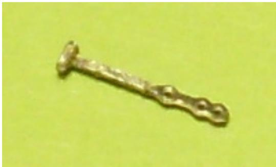
Das **Ausgleichsgewicht** (9) mittig um 180° zusammenklappen, so dass die Ösen übereinander zu liegen kommen. Am Hammerförmigen Ende die beiden seitlichen Laschen ebenfalls aufdoppeln (jeweils entgegengesetzt), so dass sich daraus das Gewicht am Ende des Hebels ergibt. Alles mit sehr wenig Lötzinne verlöten.
